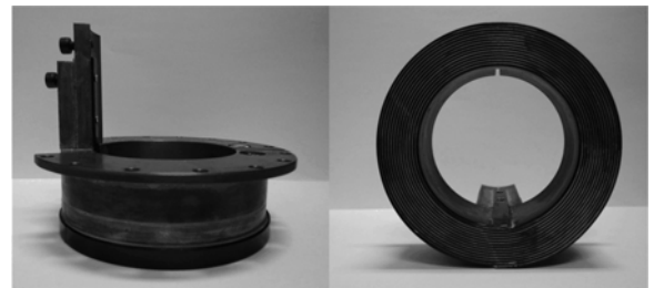
图 2 Feshbach 线圈及热沉实物图
