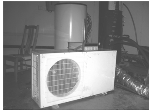
图 1 多功能太阳能热泵样机制热水实验台 Fig. 1 Prototype of the MSAHP in water heating mode
