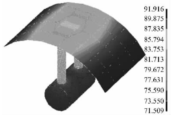
图 4 典型温度分布计算结果
