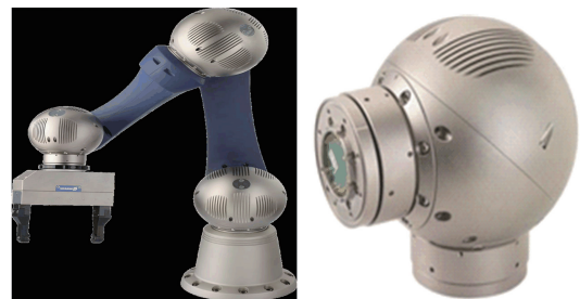
图 3 6 轴模块化机械臂以及单关节构型
